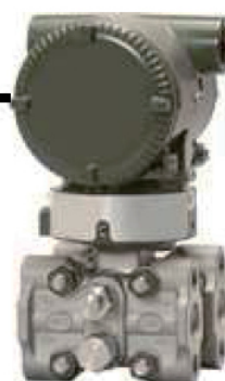
差圧伝送器 (横河社製) 出力信号: 4~20mA DC2線式
